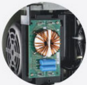
วงจรกรองสัญญาณรบกวน แยกออกจากแผงวงจรหลัก
